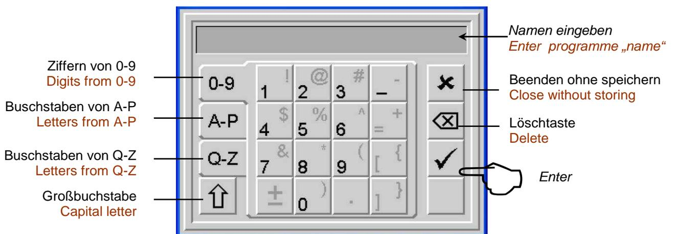
Neuen Namen für das aktuelle Programm aus dem RUN-Modus eingeben. Mit Enter zurück in den RUN-Modus.
