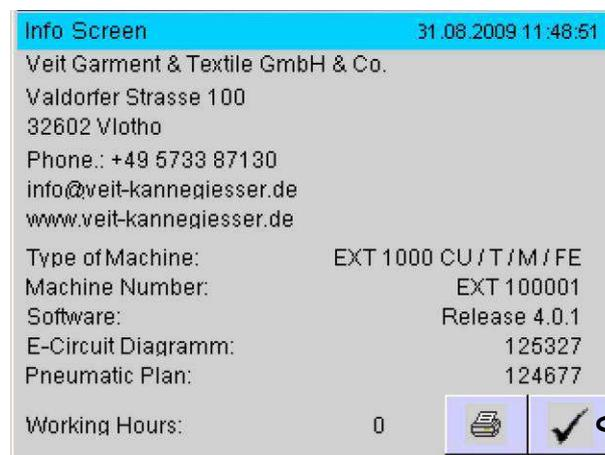
Maschinenspezifische Daten werden bei der Montage unter Setup Einstellungen eingegeben
