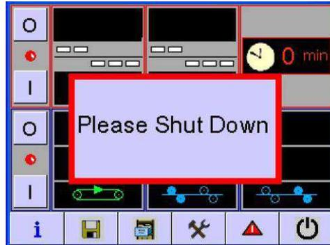
*Nach Ablauf der eingestellten Zeit der Abschaltautomatik bleibt die Maschine stehen.*
