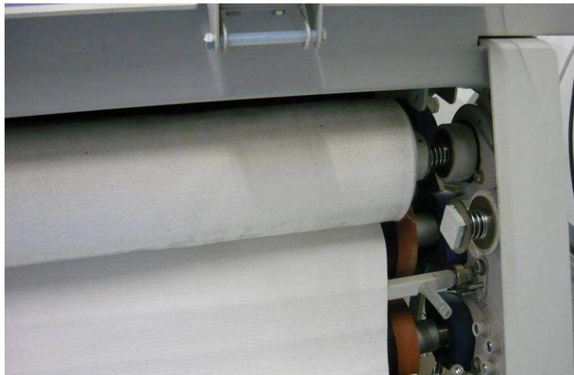
Aufwickelstange einlegen. Reinigungstuch über Aufwickelstange führen. mit Klebeband fixieren, Reinigungstuch durch Drehen der Aufwickelstange aufwickeln.
